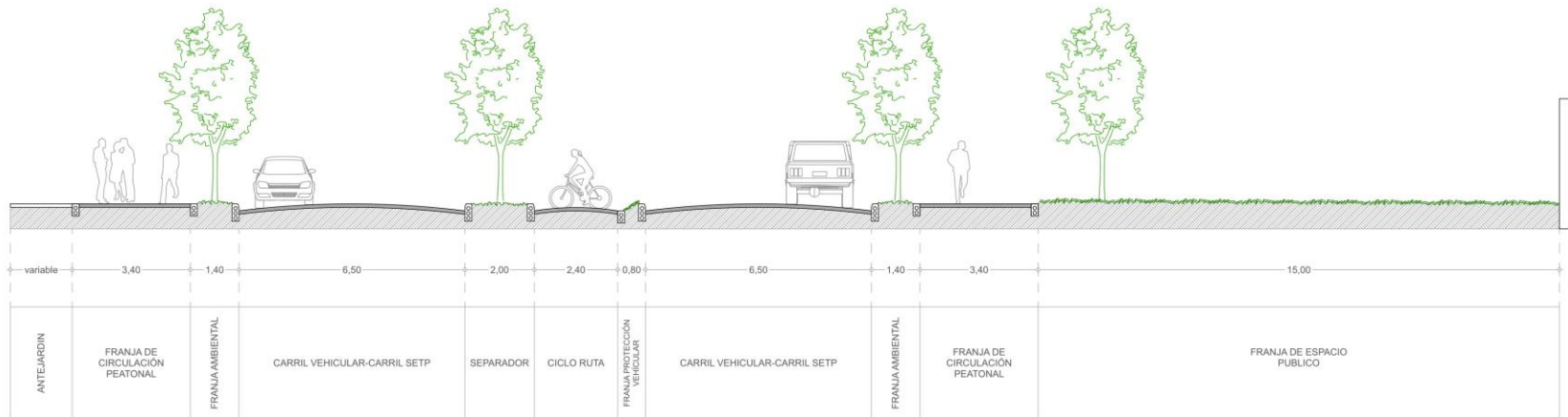
PERFIL EJE VIAL ARTERIAL COSTADO NORTE
