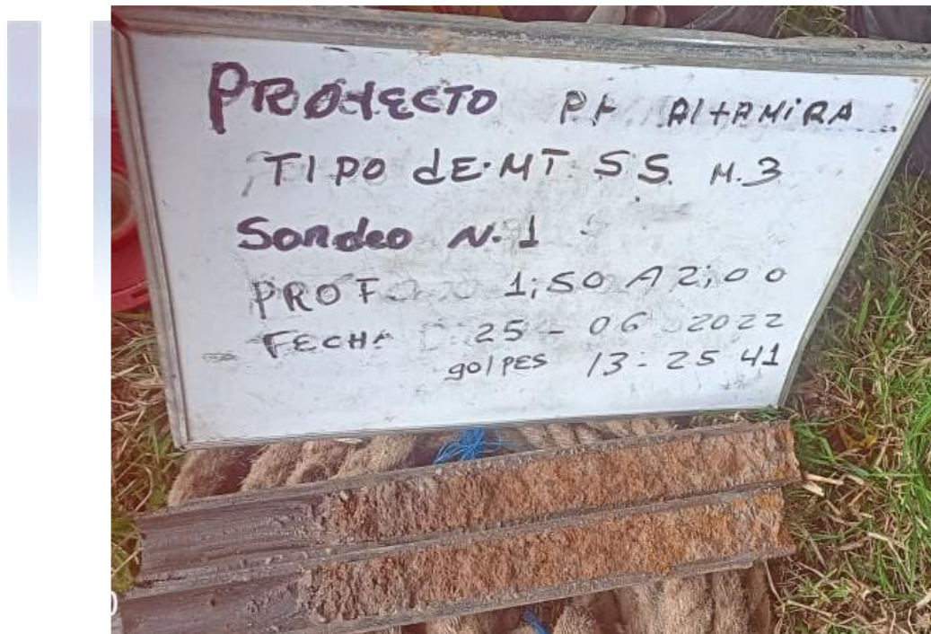
Figura 19. Depósito de caída de ceniza fina obtenido en un sondeo geotécnico.
